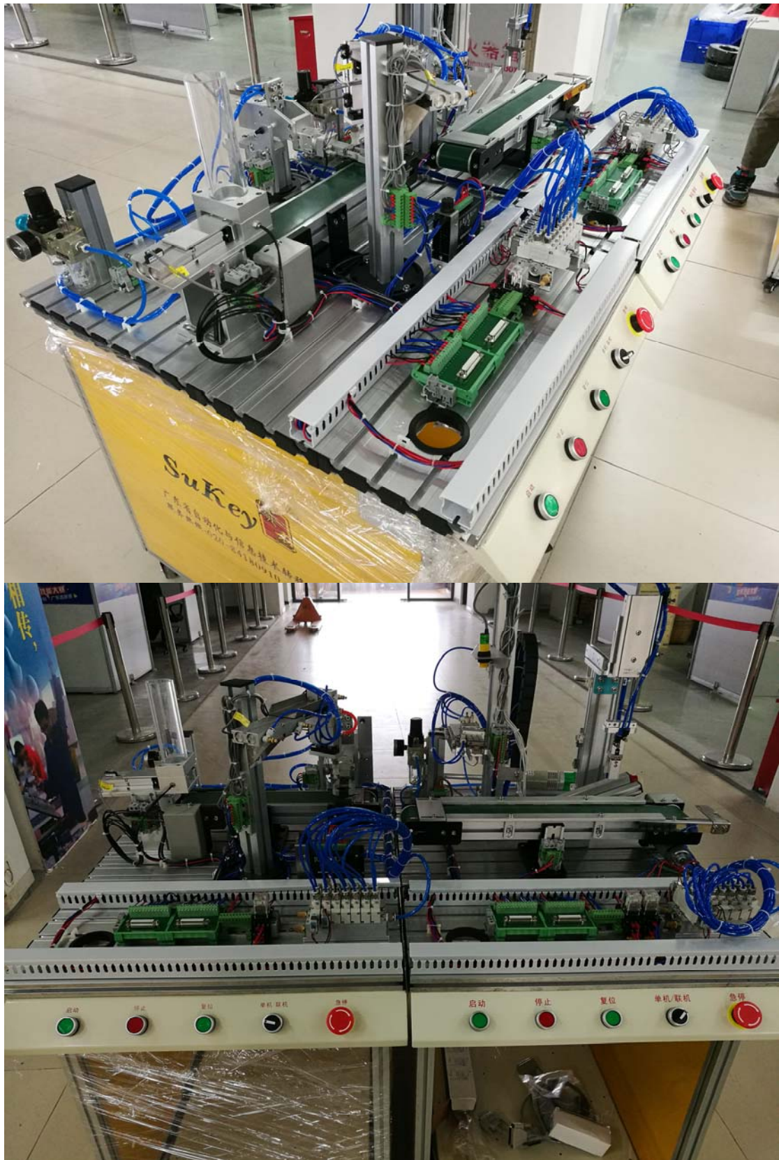
SkPLC3 II-1型可编程序控制系统设计师（三、四级）实训/考核设备
